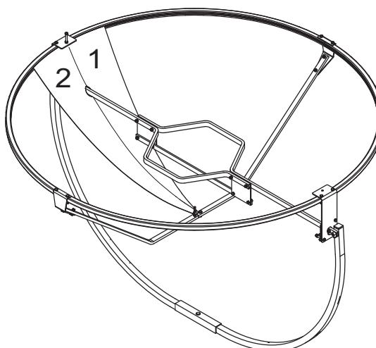
Bitte die Bleche 1+2 sowie 23+24 (Bleche mit Ausschnitt) nicht mit der Blechschraube Z13 am Tragring R1 befestigen.
