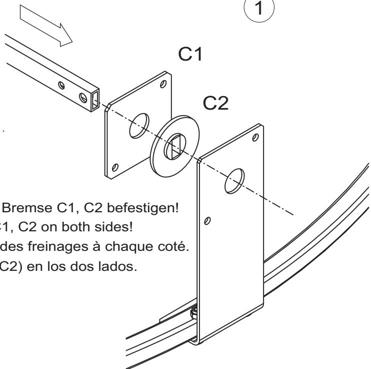
Auf beiden Seiten die Bremse C1, C2 befestigen!
